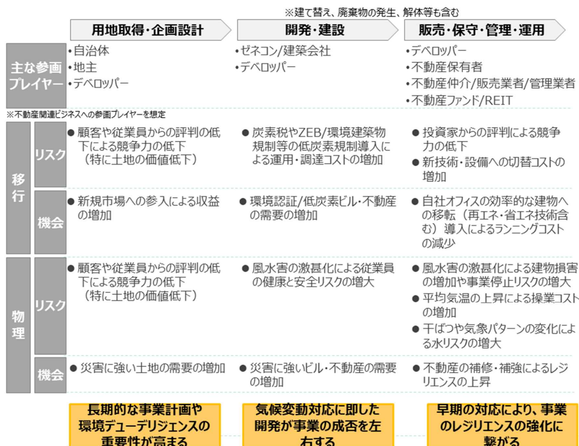
図表 39 不動産における事業の各段階（分野）の代表的な気候変動リスク・機会
